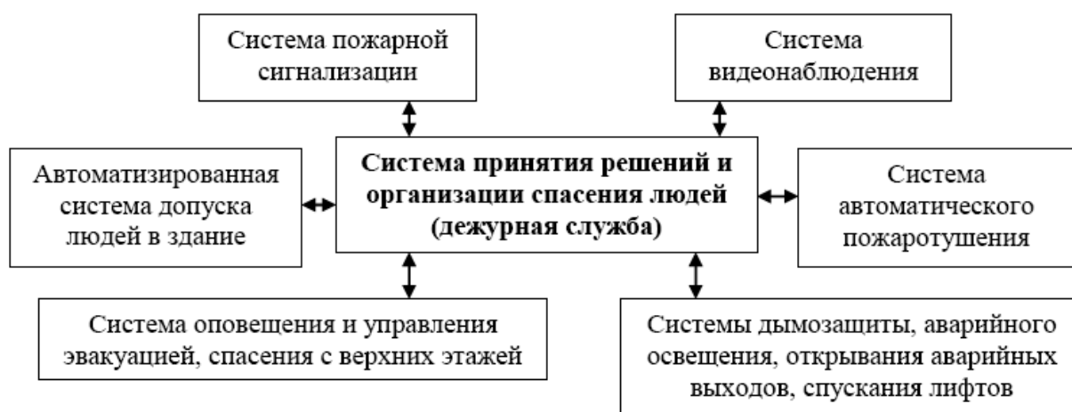
Рисунок 2 – Вариант построения комплексной системы безопасности в здании
